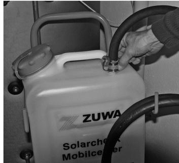
2. Rücklaufschlauch befestigen.
